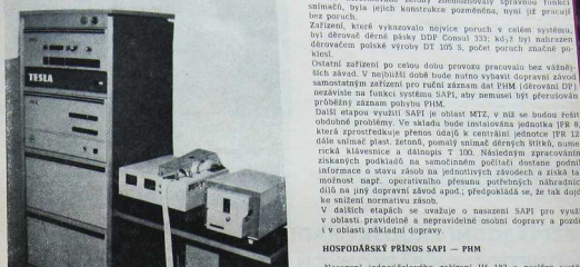
Část systému SAPI — PIM v CSAD Znojmo: JPR-12, JPN-16, dešovát a snímač dárné pásy
