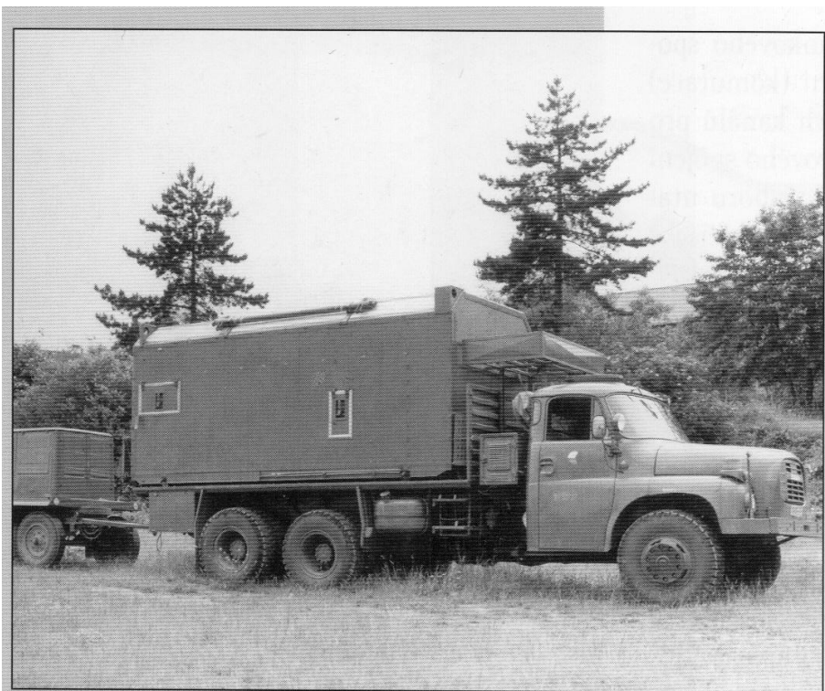
Počítač MOMI-2 v izotermickém kontejneru na automobilu Tatra 148
