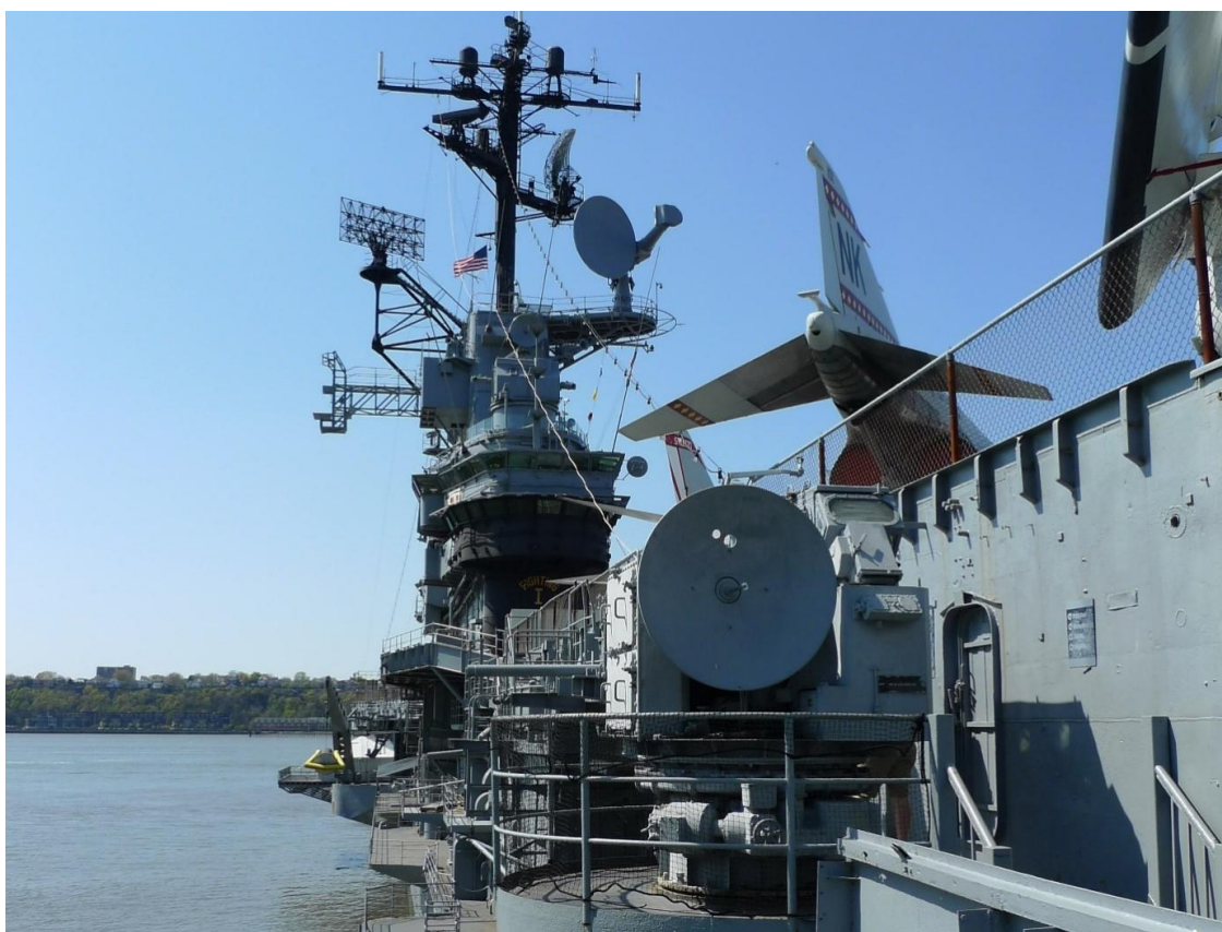
Obr. 5. Systém MARK 56 na letadlové lodi Intrepid (Zdroj Vojenský historický ústav Praha)
