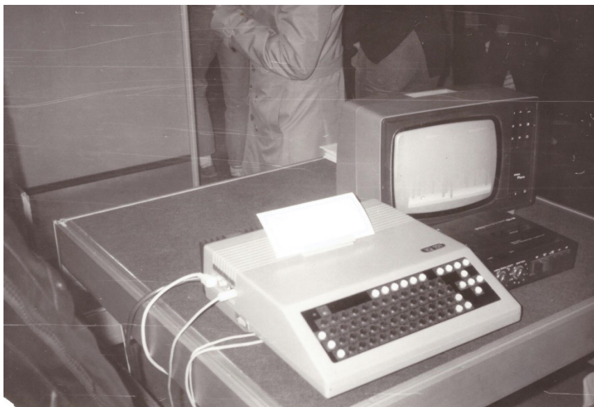
Školní mikropočítač IQ 151 pro výuku programování v jazyku BASIC na podnikové průmyslové škole a učilišti TOS Kuřim (Foto archiv autora)
