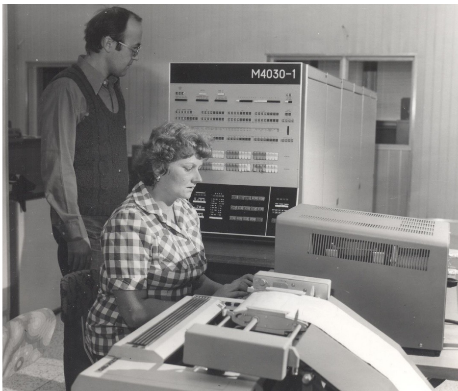
Vedoucí technik údržby počítače s operátorkou u ovládacího pultu a terminálu počítače M 4030-1 při profylaktickém testu (Foto archiv autora)
