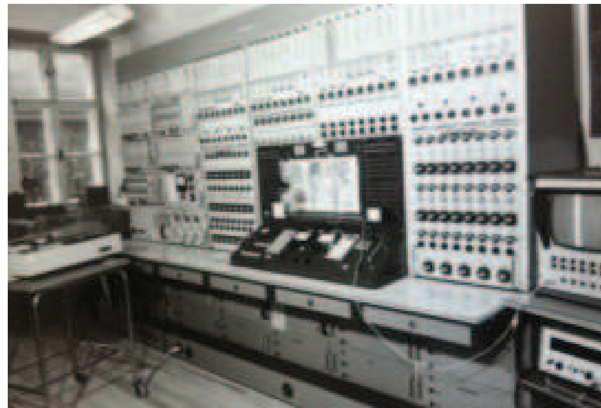
AP3M-1 (v pozadí 2 pomaluběžné elektronkové osciloskopy ODA, před nimi na vozíku bubnový servomechanický zapisovač BAK II a vpravo od počítače na vozíku tranzistorový osciloskop ODA 250)
