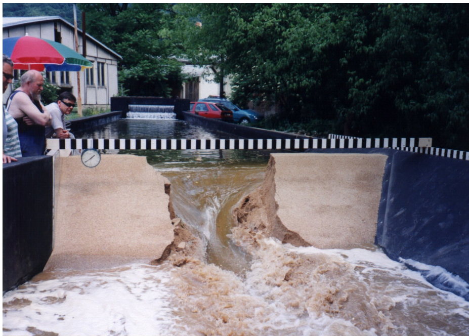
Simulace protržení hráze v testovacím vodním kanálu VUT Brno Brno Rozdrojovice
