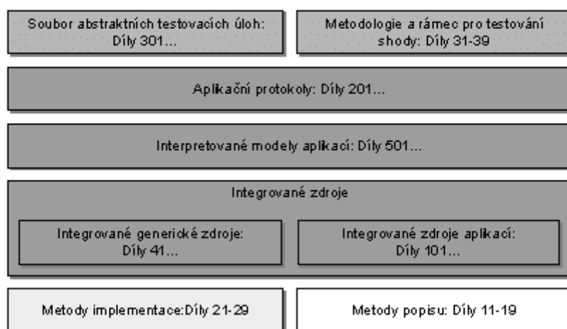
Obr.1 Struktura normy ISO 10303 STEP
